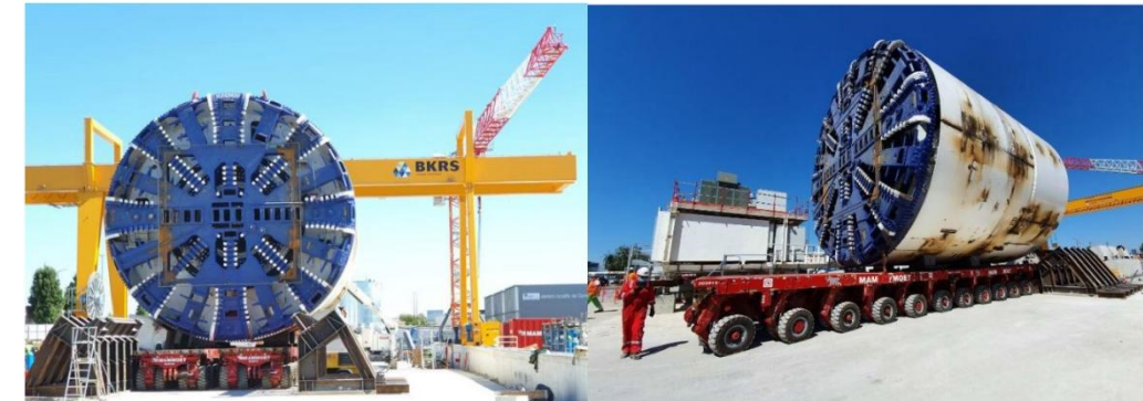
Figure 41 : Bouclier d'un tunnelier
