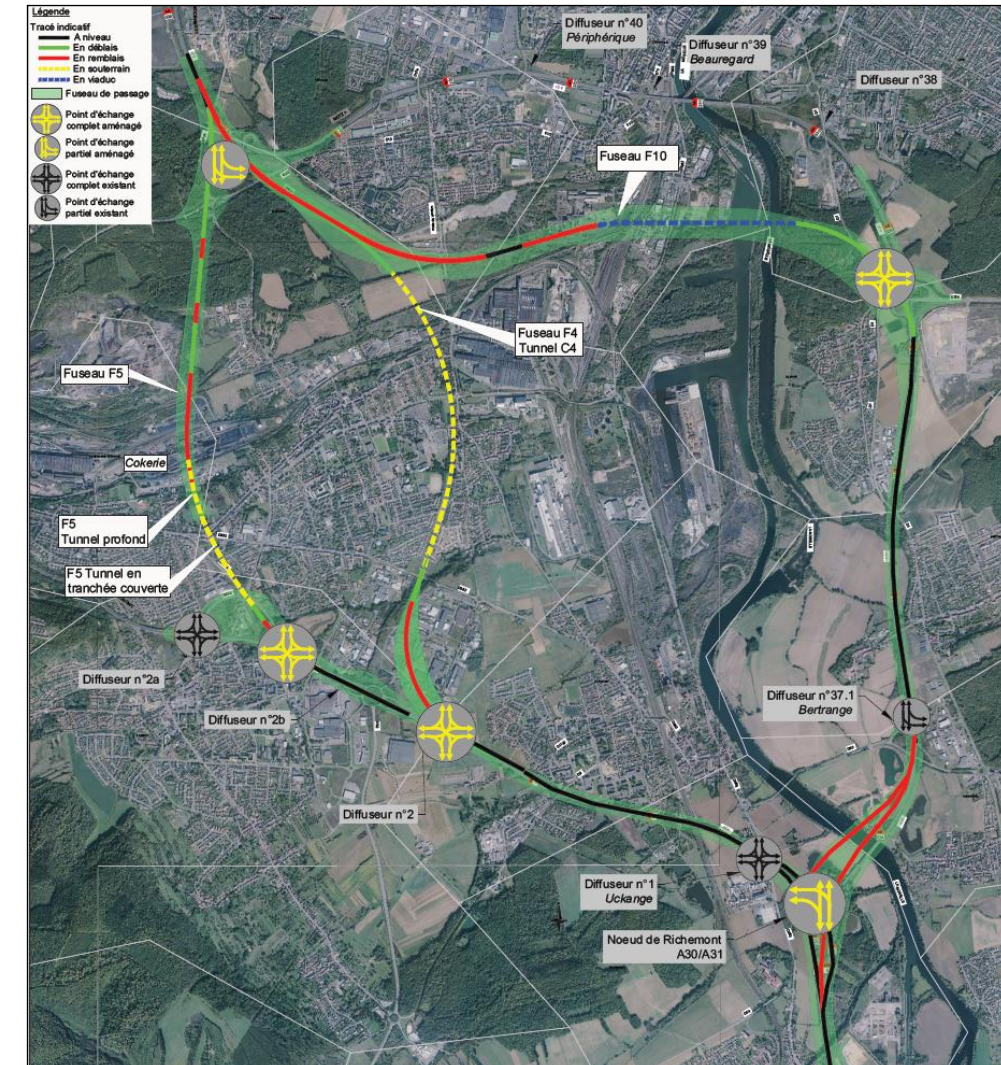
Figure 17 : Tracé des variantes retenues, présentées en concertation préalables (Source : Études préalables, Ingérop, Juin 2022)
